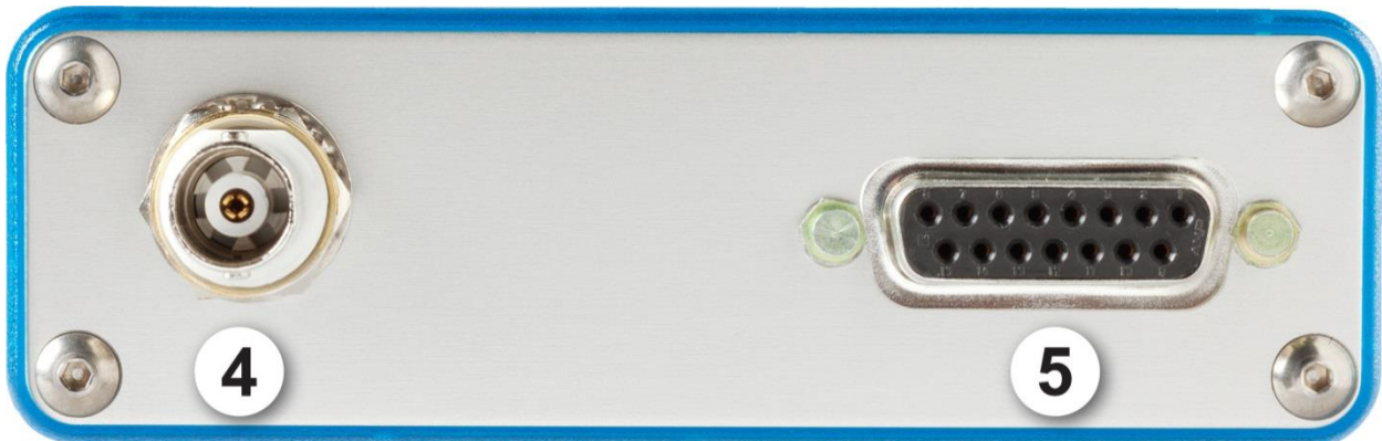
Illustration 1-3 Connecteurs M-LINK (côté DB-15)
