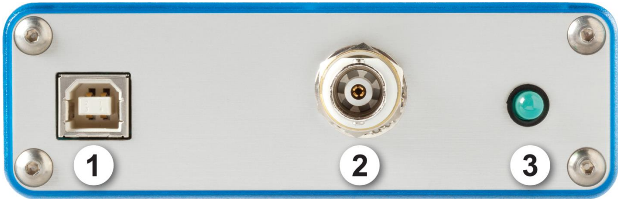
Illustration 1-2 Connecteurs M-LINK (côté USB)
